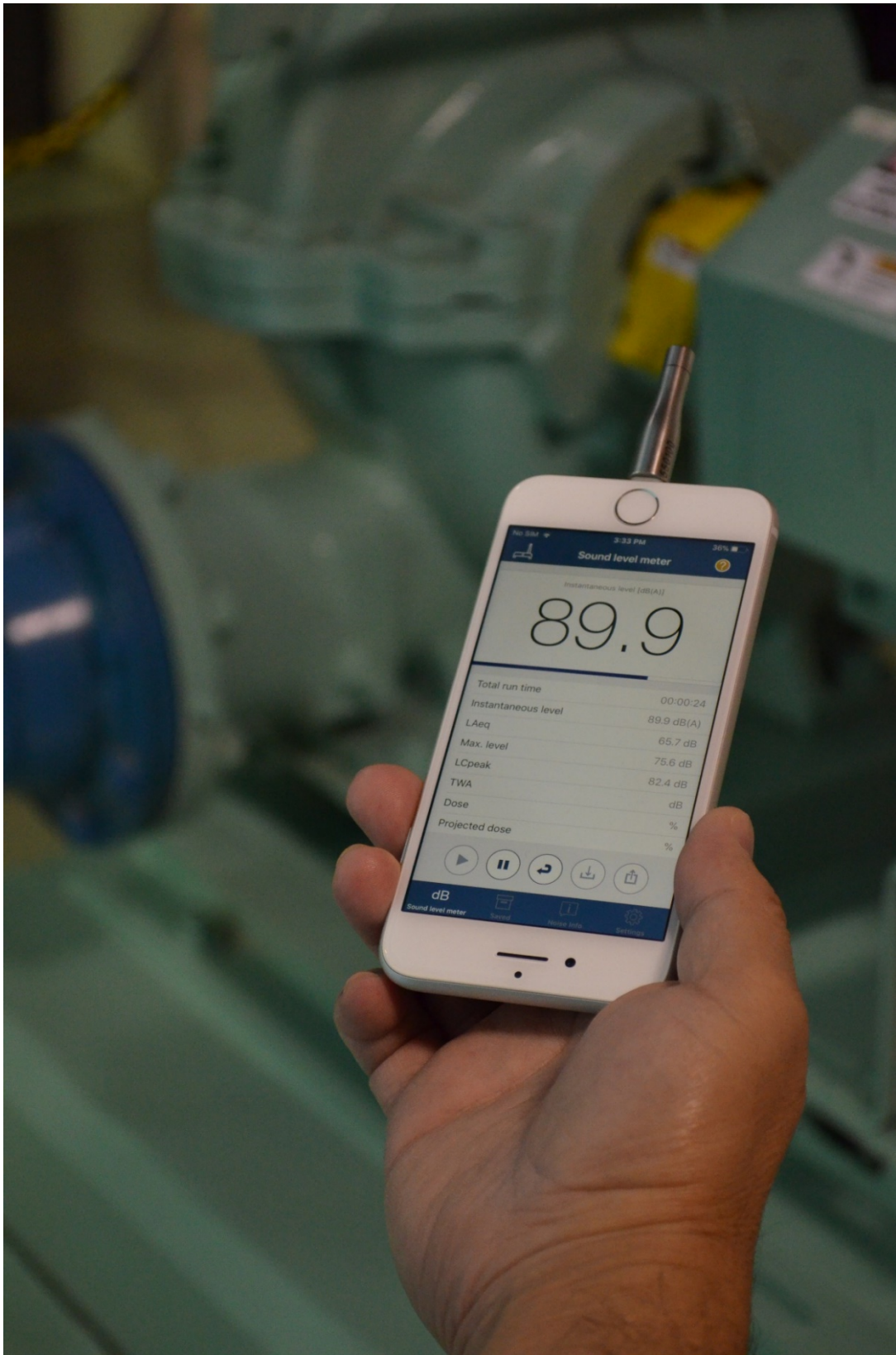
Figura 1. La pantalla principal de la app "Sonómetro" de NIOSH (se la muestra con un micrófono externo en un iPhone 8)
